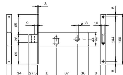
Serrure en acier GALVANISÉ à larder horizontale. FERMETURE LATÉRALE. À cylindre ovale. Coffre 44 mm en acier galvanisé.
