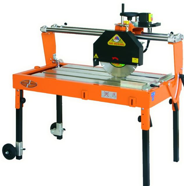
Robuste, précise, polyvalente et économique. Vraiment précise avec coulissement de la tête de sciage sur deux barres en acier chromées et rectifiées. Elle est équipée d'une pompe submergée située dans le banc pour la récupération de l'eau de refroidissement du disque. Mouvement vertical de la tête par volant pour un réglage stable et rapide. Tête inclinable pour des coupes à 45°.
