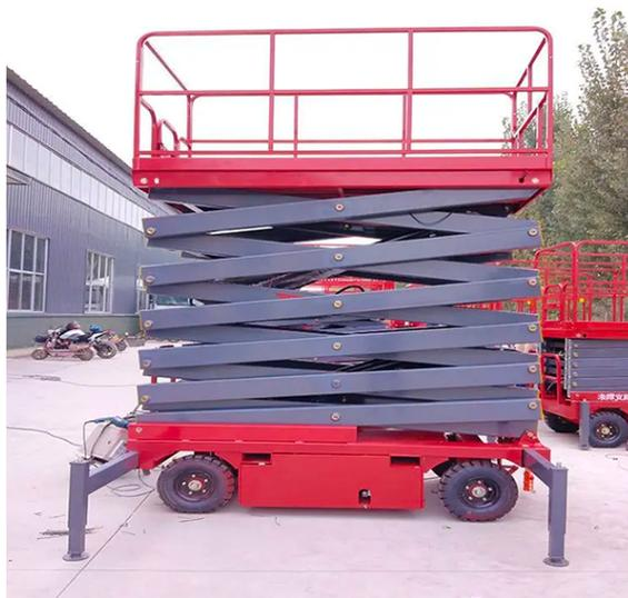
Nacelle ciseau électrique SJY0.5-11 est principalement constituée d'une structure de levage à fourche de cisaillement, constituée d'un tube rectangulaire en acier au manganèse en acier
